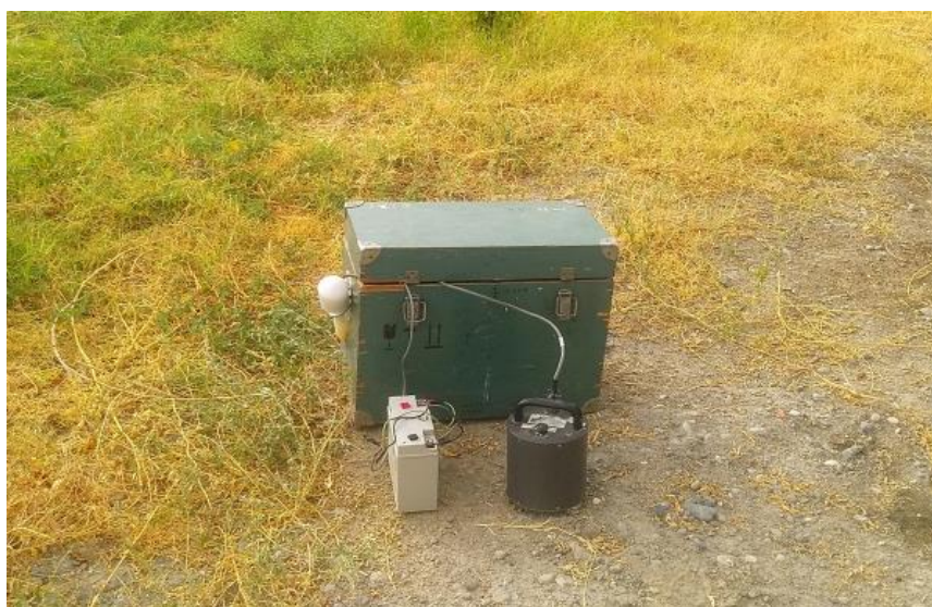
3-расм. Guralp CMG 6TD сейсмометри (велосиметр) ёрдамида шовқин (микротремор) даражасини ўлчаш жараёни.
